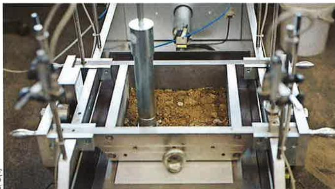
Im Labor werden Bodenproben wie etwa mit dem neuen Großrahmen-schergerät auf dem neuesten Stand der Technik untersucht.
